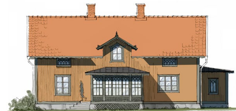
Exempel på en handskiss där befintligt hus får en ny takkupa, ny glasveranda samt en ny groventré på gaveln.
